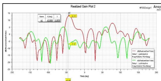
شکل ۲۱. نتایج چرخش پرتو در \theta_{str} = -45^\circ و \varphi_{str} = 0^\circ حالت دوم
