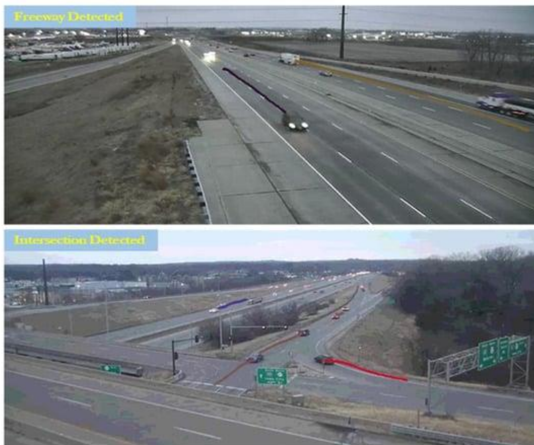
شکل ۱۰. ردیابی وسیله نقلیه و طبقه‌بندی نوع جاده
